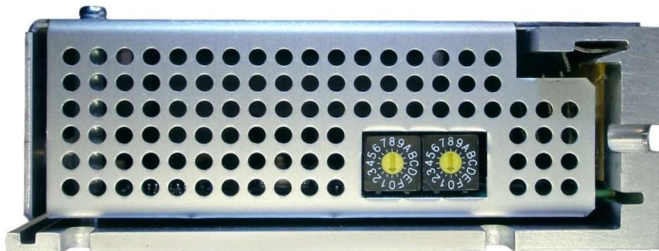
Das Einstellen der Adresse erfolgt hexadezimal. Für eine Adresse bis 15 bleibt der linke Drehschalter auf Null. Für höhere Adressen wird die linke Drehschalterstellung mit 16 multipliziert und zum rechten Wert addiert.
