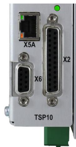
Die Eingänge sind optisch getrennt und sowohl für 24V als auch für 5V ausgelegt (siehe Typenschlüssel). Die Eingänge können über die Parameter-Daten (siehe 1.2) deaktiviert werden.
