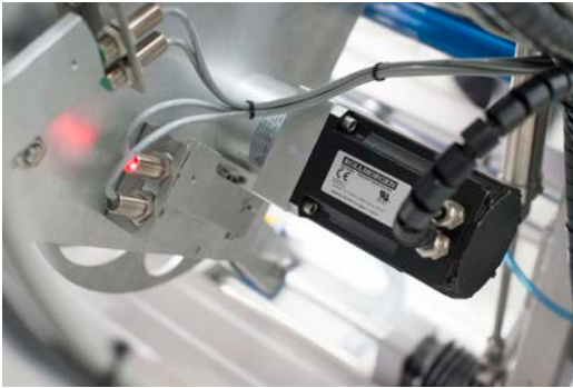
Antriebslösung im Etikettierer einer Verpackungsmaschine mit AKM31S
